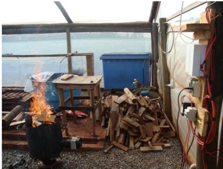
Figura 9. Queimador a lenha usado para aquecimento do ar da estufa no inverno.
