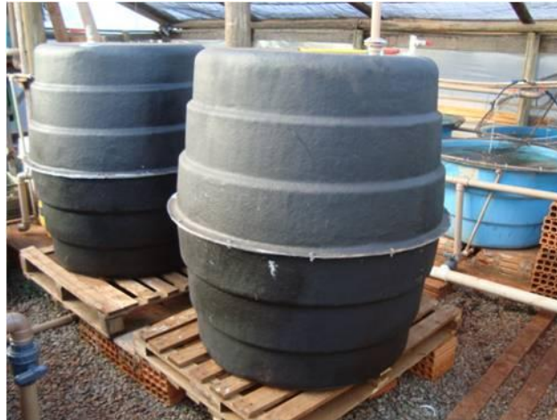
Figura 3. Biodigestor para tratamento de efluentes, produção de biogás e biofertilizantes.
